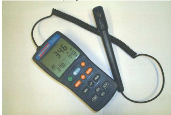
Figura 1: Aparelho medidor de CO 2 , temperatura e umidade utilizado neste trabalho.
