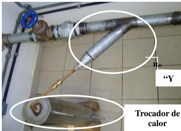
Figura 26. Sistema de resfriamento e coleta dos gases da exaustão do motor diesel.
