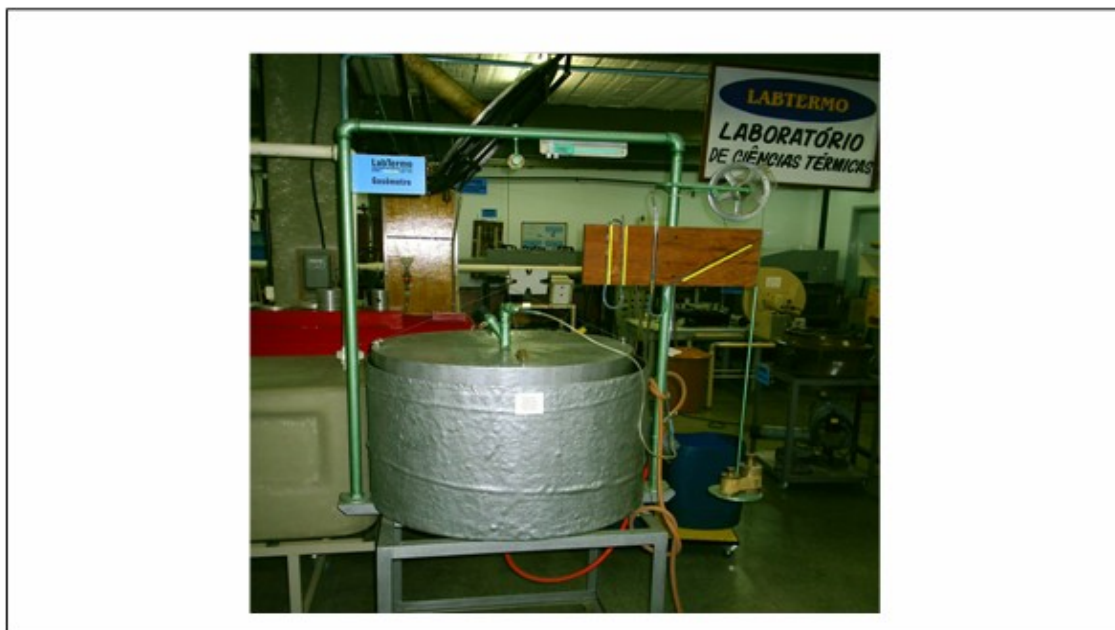
FIGURA 7 - Foto do gasômetro utilizado
