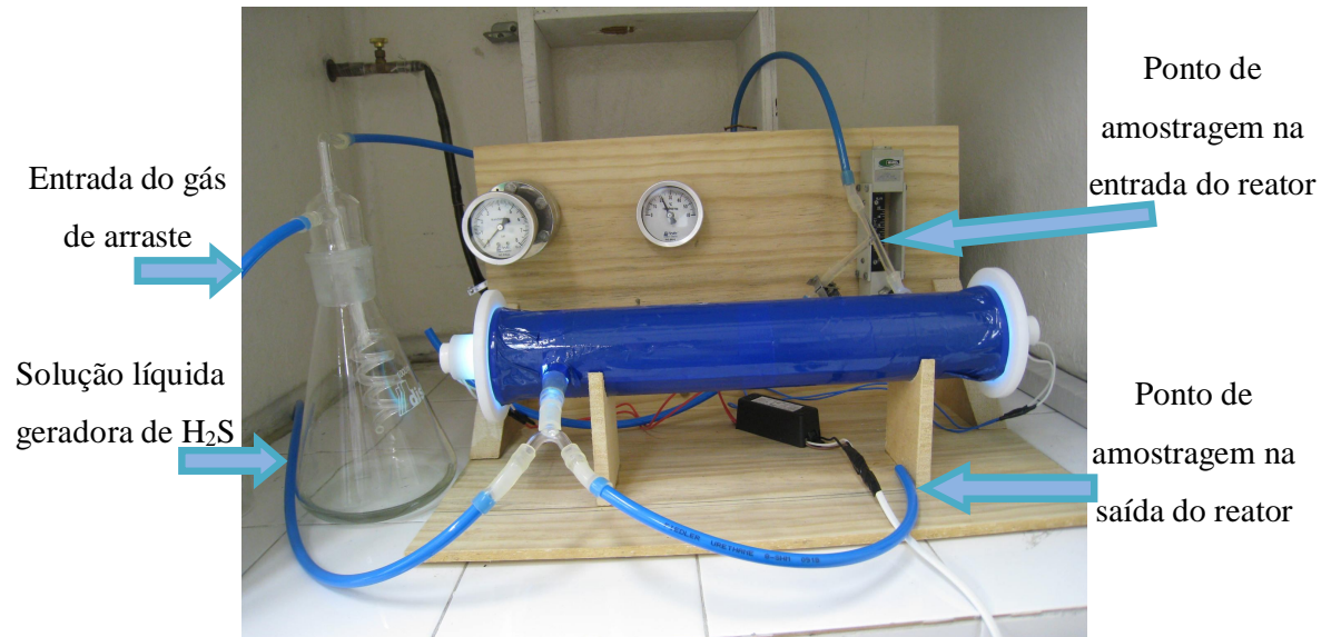
Figura 6 - Estrutura do reator piloto.
