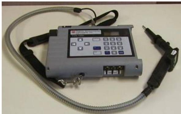
Este foi calibrado através da medição de metano em sacos de tedar contendo amostras padrão em concentrações definidas (preparados em laboratório), além de ser pré-calibrado pela empresa fornecedora do equipamento.
