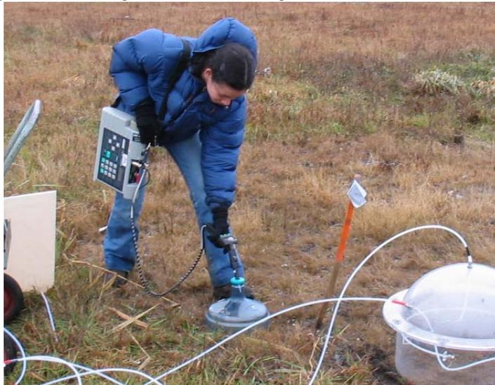
A concentração de odor foi medida através de olfatometria dinâmica a partir de amostras coletadas com câmara de fluxo dinâmica (Figura 15) em sacos de TEDLAR<sup>REG</sup> (Figura 14), conforme procedimentos e equipamentos descritos neste trabalho.
