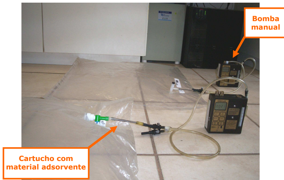
Figura 17 – Transferência do gás do saco para o adsorvente.
