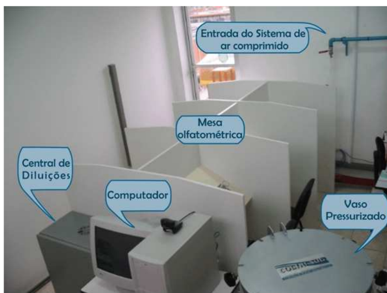
Figura 20 – Olfatômetro de diluição dinâmica Odile, versão 2000 e demais unidades.
