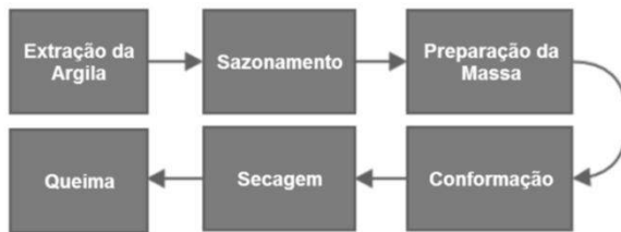
Figura 5 – Etapas produtivas das indústrias de cerâmica vermelha (olarias).
