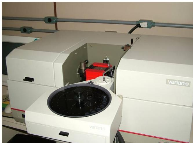
**Figura 13.** Espectrômetro de Absorção Atômica com forno de grafite.
