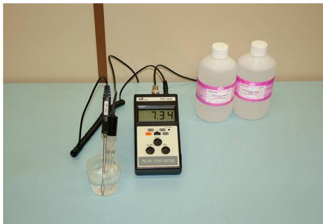
**Figura 10.** pHmetro utilizado para as medidas de pH das águas de chuva das estações coletoras.
