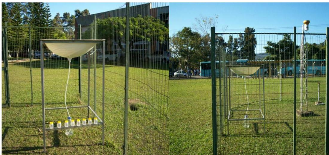
**Figura 6.** Coletor volumétrico instalado no campus da UFSC.
