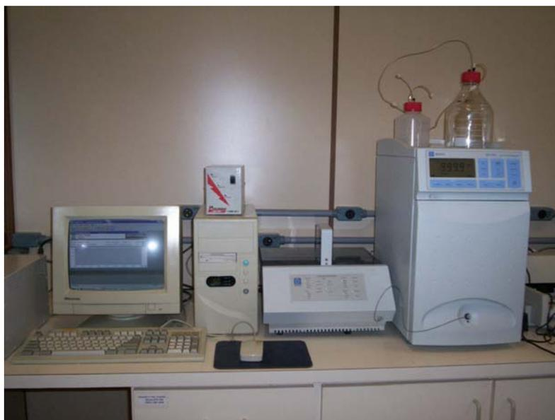
**Figura 11.** Cromatógrafo iônico Dionex – Modelo DX-120.
