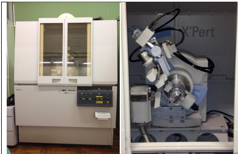
Figura 14 – Difratorômetro de raios X utilizado nas análises de caracterização: à esquerda: aparelho em operação; à direita, detalhe do corpo principal.
