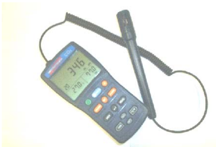
Figura 7: Aparelho medidor de CO 2 , temperatura e umidade utilizado neste trabalho.
