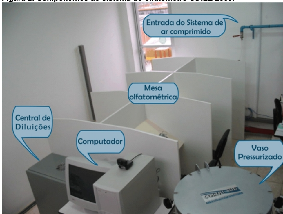
Figura 2: Componentes do sistema do olfatômetro ODILE 2000.
